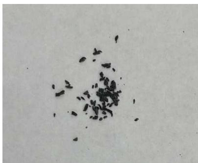
一方、切り粉や鉄粉も微小金属検出機ではよく反応します。鉄粉は 1 粒づつこそ小さいものの、複数ある事で磁気センサーがその磁界の大きさを合算して、検出に至ります。また鉄粉だけでなく、SUS 粉もすでに応力が掛かった状態である事から、検出する事が可能になっています。
